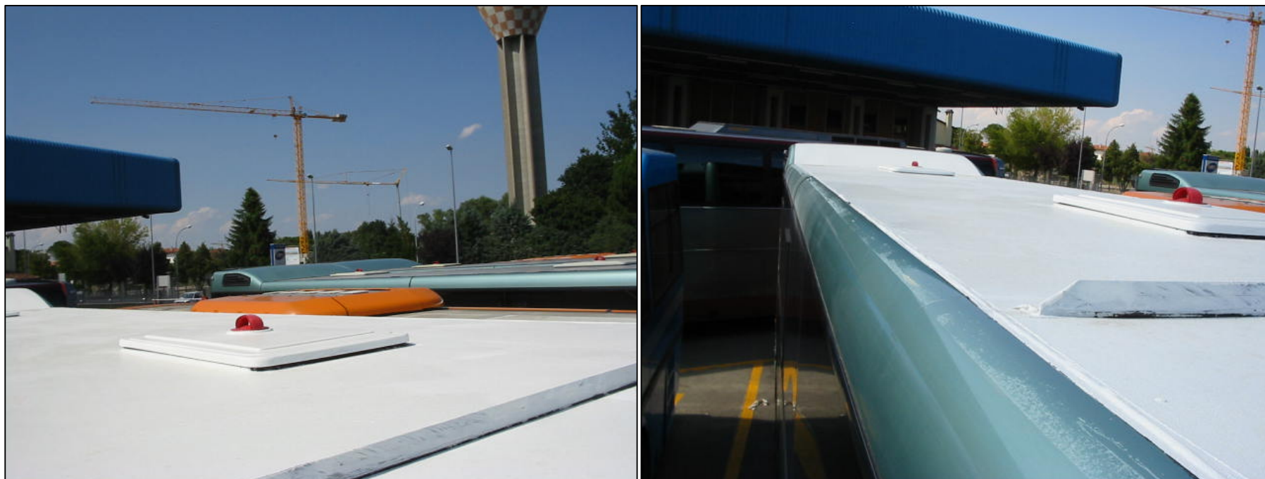
Foto 3 – 4 Autobus (trattati e non) disposti nel piazzale per la rilevazione della temperatura interna.
