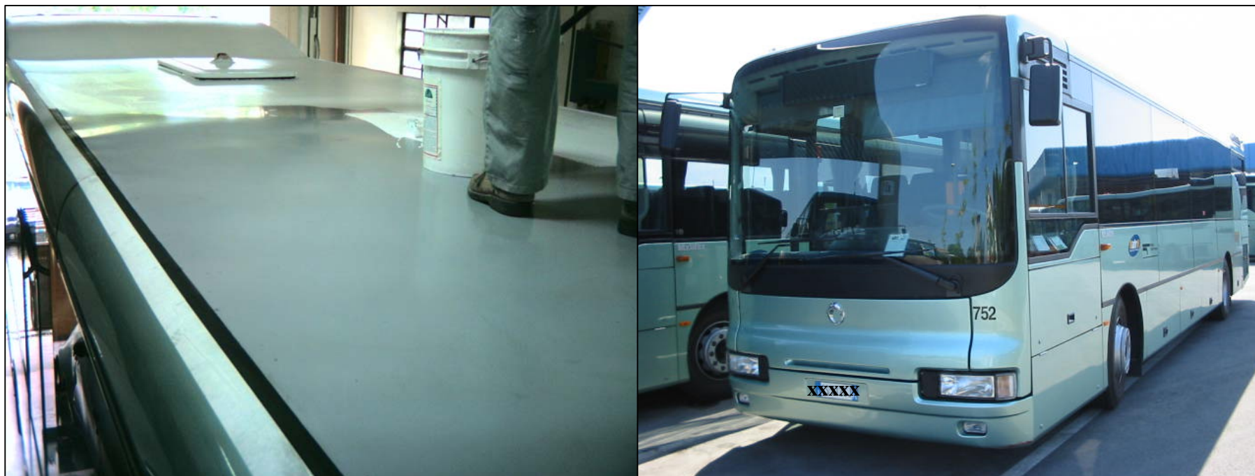
Foto 1 - 2 Applicazione Super Therm ed Enamo Grip sul tetto di un autobus.
